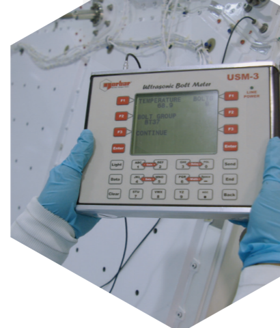
Mesure USM-3 de la longueur des boulons Hardpoint des palettes du Spacelab utilisés sur STS-123 au Kennedy Space Centre
