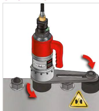
**HINWEIS: Achten Sie darauf, dass die Reaktionsstelle rechtwinklig zur Drehmomentplatte liegt, um den Antriebsvierkant nicht zu überlasten und die Lebensdauer des Werkzeugs zu verlängern. Wenn sich die Drehmomentplatte unter der Last neigt, liegt die Reaktionsstelle nicht mehr rechtwinklig.**
