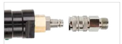
Branchez le côté d'admission de l'unité de commande de lubrification à l'alimentation pneumatique principale. Utilisez une conduite de 1/2" (12 mm) minimum et d'une longueur maximale de 5 m. (Des conduites plus longues diminueraient la performance de l'outil.).
