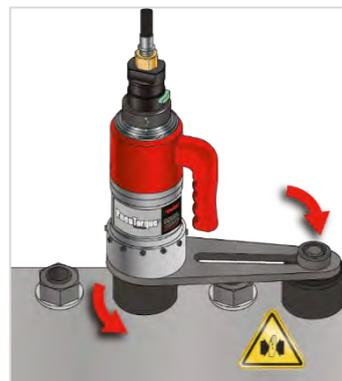
**FIGURE 8 – Exemple de réaction dans le sens inverse des aiguilles ⤵**
