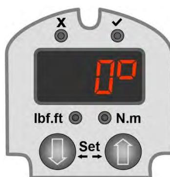
FIGURA 5b - Visualizzazione dell'angolo dello strumento
