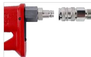
Collegare il lato di ingresso dell'unità di controllo della lubrificazione (figura 1-B) alla rete di fornitura dell'aria (figura 1-A) usando un tubo flessibile dal diametro minimo di 1/2" (12 mm). Evitare di usare tubi flessibili da 1/2" con una lunghezza superiore ai 5 metri dall'erogatore all'unità di regolazione della pressione, perché diminuiranno la prestazione dell'avvitatore.
