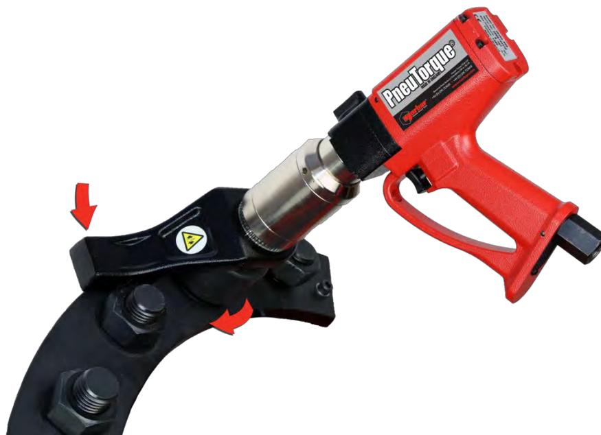
FIGURA 8 – Stringere il Fissaggio in Senso Orario
