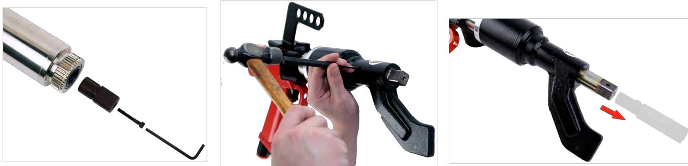
**FIGURA 11** – Sostituzione Dell'attacco Quadro
