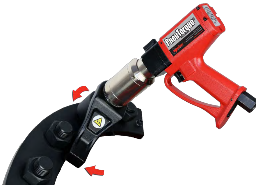
FIGUR 9 – Løsne festeinnretning med klokken
