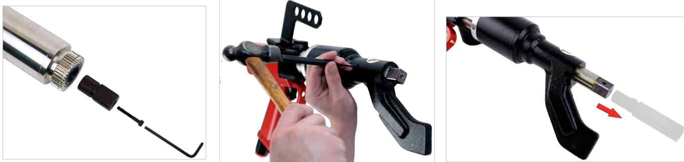
FIGUR 11 – Bytte Av Firkantdrift
