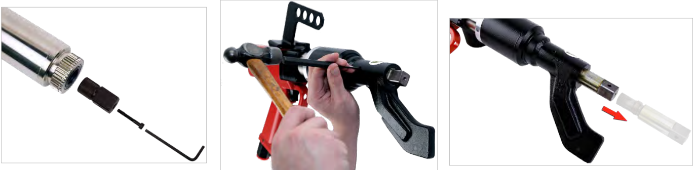
ILUSTRACIÓN 15 – Sustitución Del Cuadro Transmisor
