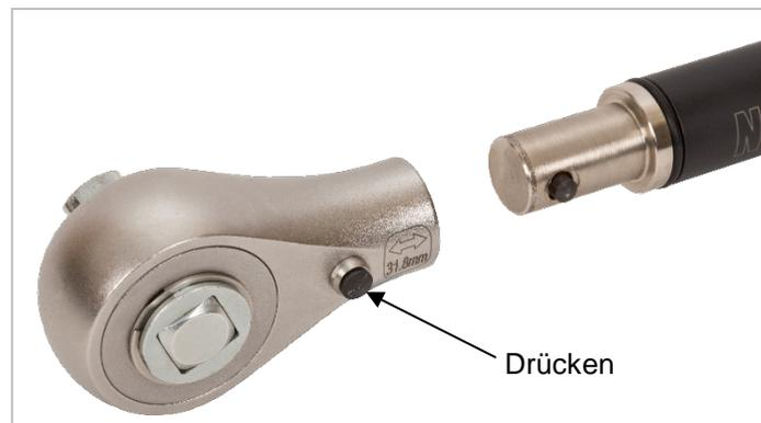
**HINWEIS:** Alle Werkzeuge von NorTronic® sind Drehmomentgriffe mit einem 16 mm langen Zapfen. Wenn Sie einen anderen Schraubenschlüsselendeinsatz verwenden möchten, drücken Sie den Knopf am Ratschenkopf und ziehen Sie den Ratschenkopf ab.
