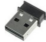
Nach dem Einstecken erscheint dieser USB-Adapter als serieller Anschluss anstelle eines Bluetooth®-Geräts. Dies soll es Ihnen erleichtern, sich mit ihm in der Software zu verbinden, und verhindern, dass er in die bestehende Bluetooth®-Hardware und -Software eingreift, die auf dem System installiert ist.
