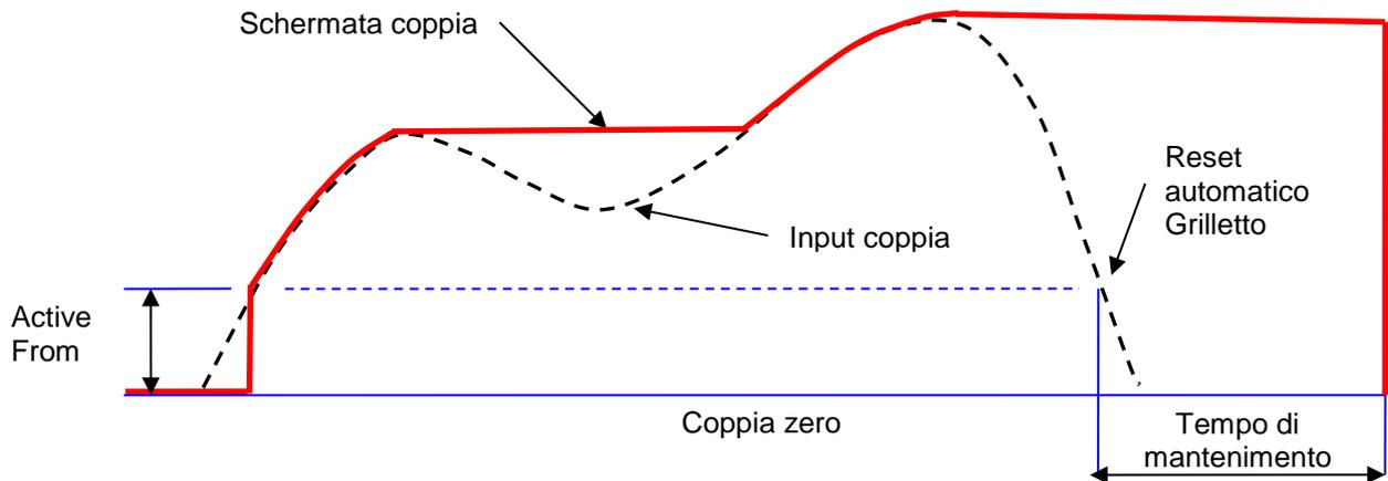
Quando viene applicata la coppia di serraggio, NorTronic® traccia l'input della coppia finché non supererà l'impostazione **Active From** (vedere pag. 20) quindi entra in modalità di picco per la coppia e l'angolo.
