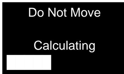
Questa schermata viene visualizzata durante il calcolo dello scostamento del giroscopio.
