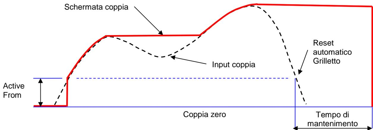
Quando viene applicata la coppia di serraggio, NorTronic® traccia l'input della coppia finché non supererà l'impostazione **Active From** (vedere pag. 50) quindi entra in modalità di picco per la coppia e l'angolo.
