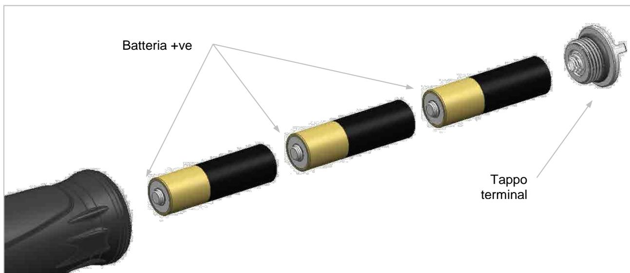
**NOTA:** Inserire nel vano dell'impugnatura il terminale positivo della batteria per primo. Ruotare il tappo terminale in senso orario per serrare e in senso antiorario per rilasciare.
