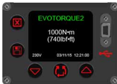
FIGURE 18 - Capacité de l'outil, tension, date et heure
