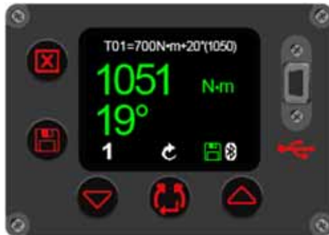
FIGURE 53 - Résultats de cible de couple et d'angle (avec Couple Final) (affiché en vert si réussi)
