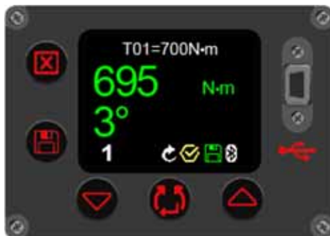
FIGURE 54 - Résultat d'audit de couple cible (montrant le couple atteint et le mouvement de sortie (boulon) en degrés)
