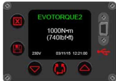
FIGURE 43 - Afficher la capacité, la tension, la date et l'heure
