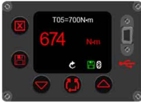
FIGURE 52 - Résultat de couple cible (illustré en rouge pour un échec)
