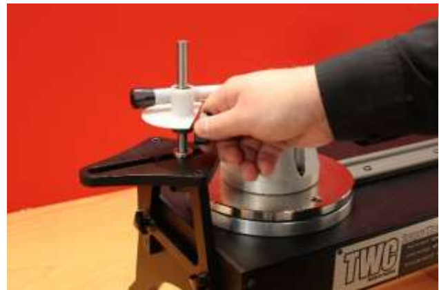
ABBILDUNG 29 – Anpassung des Stützpunkts der kurzen Stützplatte
