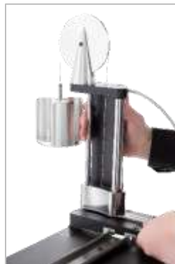
ABBILDUNG 12 – Aufschieben der Gegengewicht-Stützbaugruppe auf die Stützschiene
