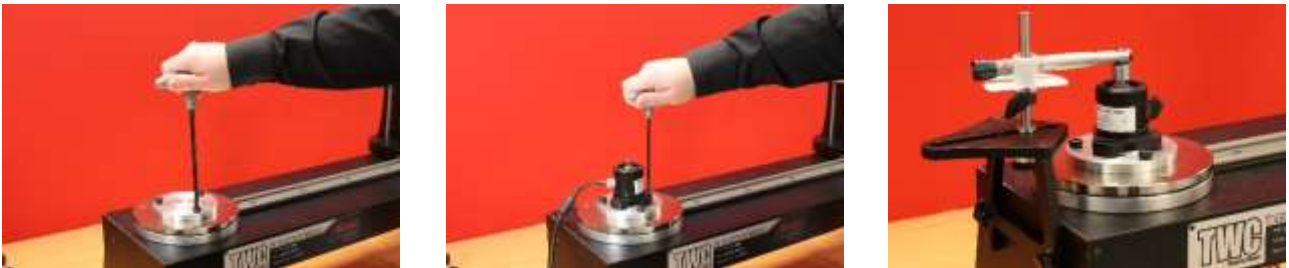
ABBILDUNG 30 – Befestigung des FMT 2 bis FMT 25 Adapterkits
