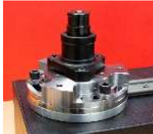
ABBILDUNG 32 – Befestigung der TWC-Winkelversatzplatte
