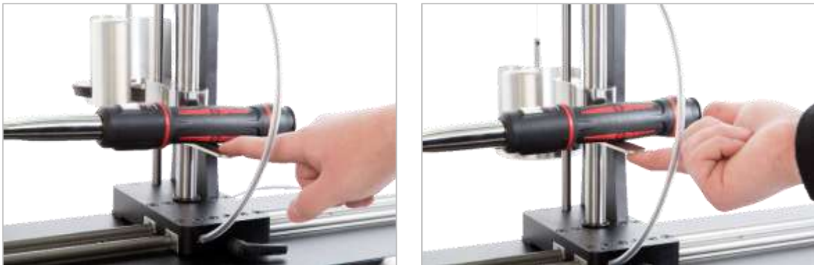
ABBILDUNG 18 – Sicherstellen, dass sich der Drehmomentschlüssel in einer horizontalen Position befindet
