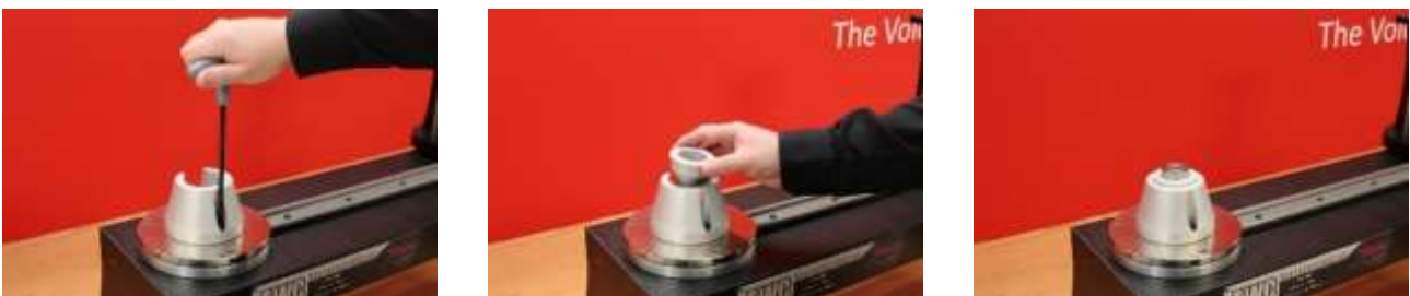
ABBILDUNG 27 – Einbau des Stützkit des statischen Umwandlers
