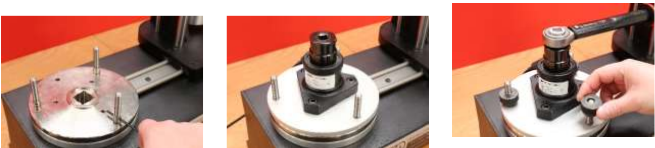
ABBILDUNG 31 – Befestigung des FMT-Schnellkupplungskits
