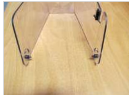
ABBILDUNG 6 – Kombination der Neoprenscheiben mit den Passschrauben
