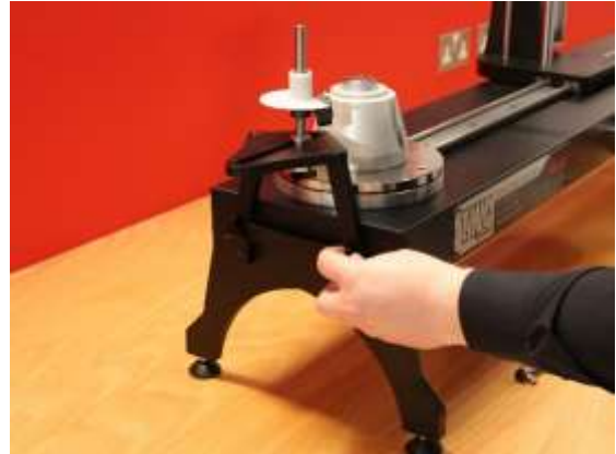
ABBILDUNG 28 – Befestigung der kurzen Stützplatte
