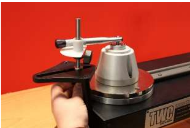
ABBILDUNG 29 – Anpassung des Stützpunkts der kurzen Stützplatte
