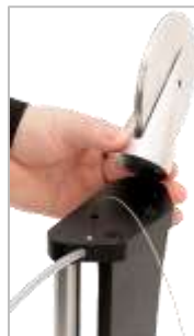
ABBILDUNG 9 – Ausrichten der Gegengewicht-Stützscheibe
