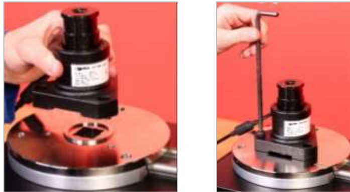
ABBILDUNG 14 – Anbau eines FMT-Umwandlers
