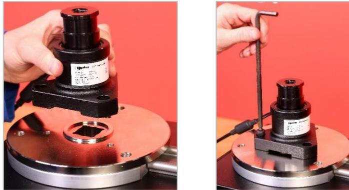
**FIGURA 14** - Montaje de un transductor montado sobre bridas
