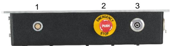
**FIGURA 2** - Vista frontal de la caja de controles
