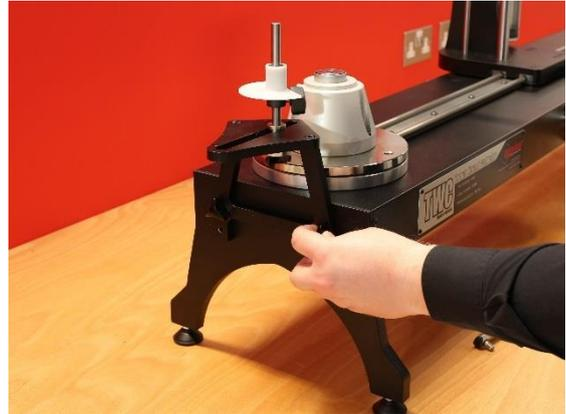
**FIGURA 28** - Colocación de la placa de reacción corta
