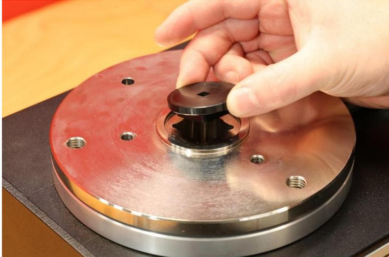
**FIGURA 26** – Inserción del adaptador del adaptador cuadrado
