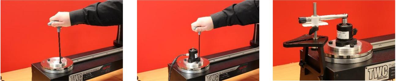
**FIGURA 30** - Colocación del kit adaptador FMT 2 a FMT 25
