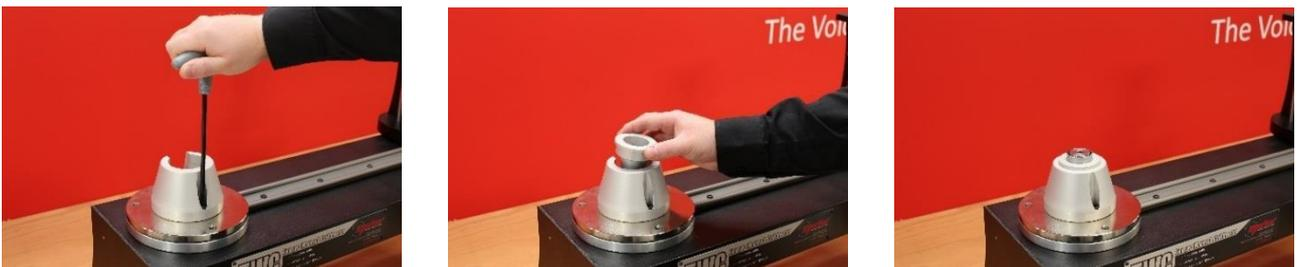
**FIGURA 27** – Montaje del kit de soporte del transductor estático.
