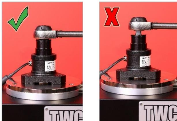
**FIGURA 15** - Colocación de una llave dinamométrica
