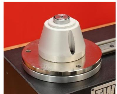
Coloque el soporte sobre el transductor y asegúrelo al TWC con los tornillos Allen suministrados.
