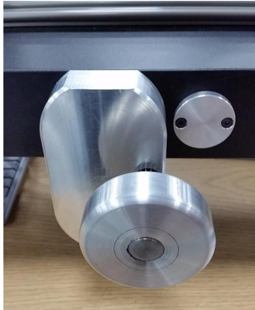
Utilice el adaptador del engranaje de accionamiento manual I/P alcanzar el valor correcto en la herramienta dinamométrica.
