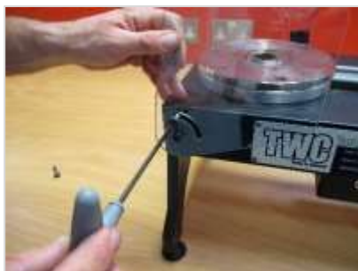
FIGURA 7 – Fissaggio della custodia
