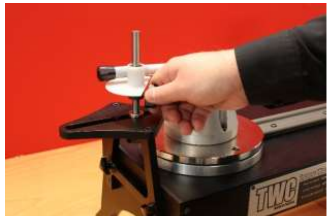
FIGURA 29 – Regolazione del punto di reazione della piastra di reazione a percorso breve
