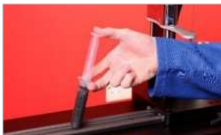
FIGURA 22 – Applicazione del lubrificante
