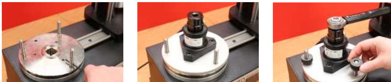
FIGURA 31 – Fissaggio del set FMT a rilascio rapido
