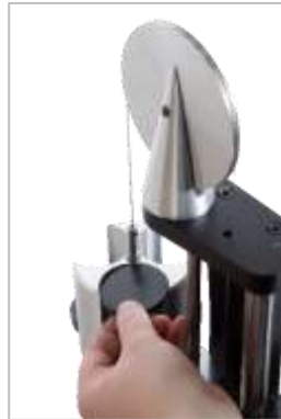
FIGURA 17 – Aggiunta di pesi al dispositivo di contrappeso
