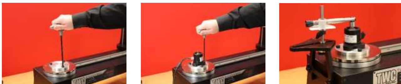
FIGURA 30 – Fissaggio del set di adattatore da FMT 2 a FMT 25
