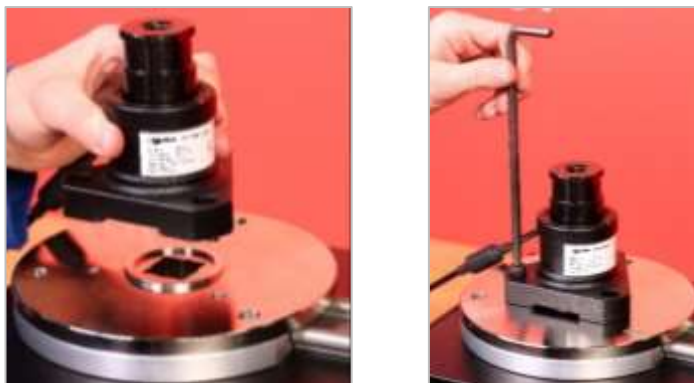
FIGURA 14 – Fissaggio di un trasduttore FMT
