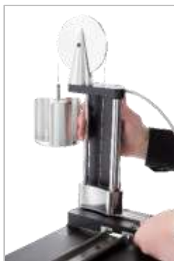
FIGURA 12 – Far scivolare l'assemblaggio di contrappeso nel binario del dispositivo
