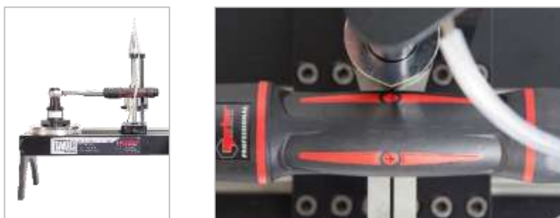
FIGURA 16 – Posizionamento di una chiave dinamometrica
