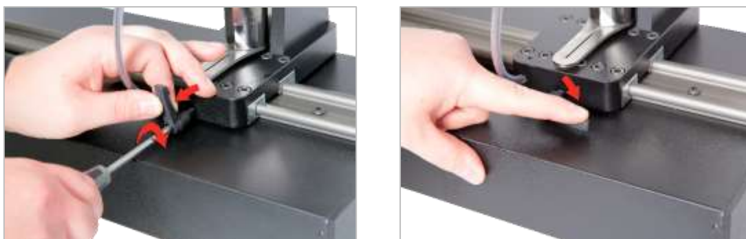
FIGURA 13 – Regolazione e impostazione della leva di bloccaggio
