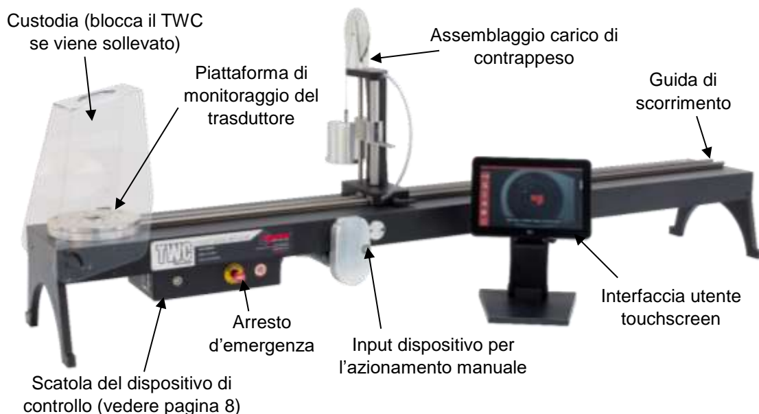
FIGURA 1 – Funzioni automatiche TWC
