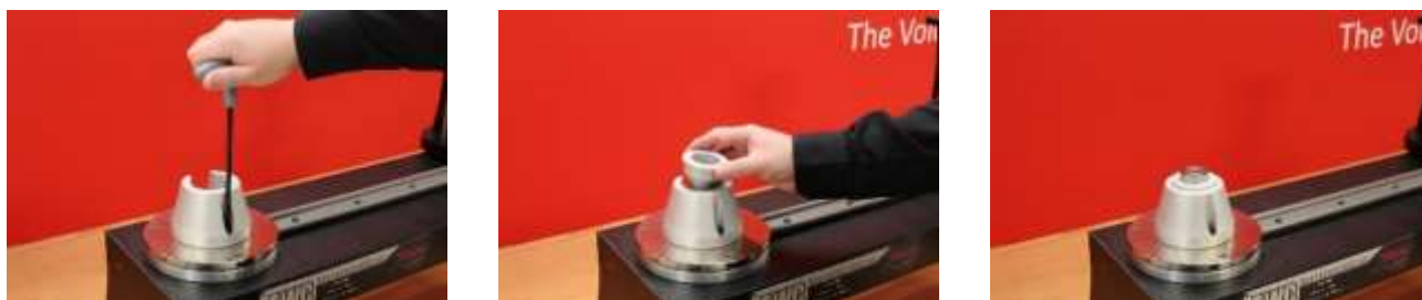
FIGURA 27 – Fissaggio del set di supporto del trasduttore statico
