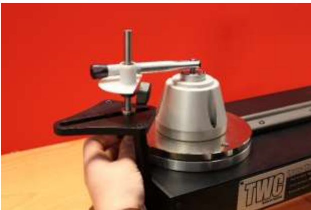
FIGURA 29 – Regolazione del punto di reazione della piastra di reazione a percorso breve
