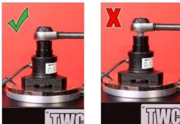
FIGURA 15 – Fissaggio di una chiave dinamometrica
