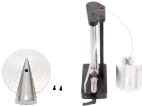
FIGURA 8 – Assemblaggio carico di contrappeso smontato
