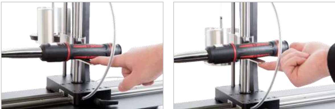
FIGURA 18 – Accertarsi che la chiave dinamometrica sia in posizione orizzontale
