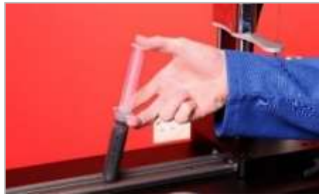
FIGURA 24 – Applicazione del lubrificante
