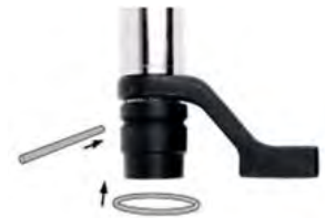
ILUSTRACIÓN 18 - Sujeción del dado
