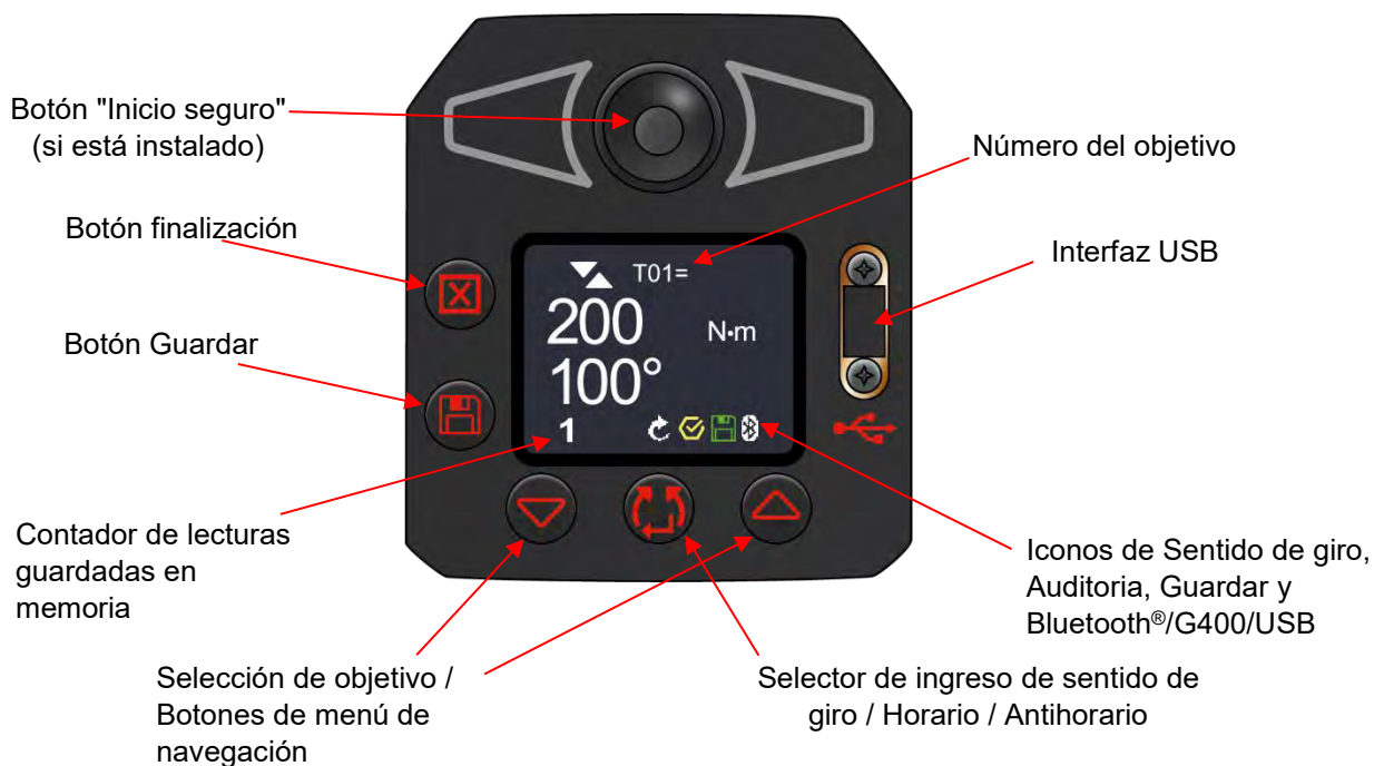
ILUSTRACIÓN 2 - Funciones de la interfaz de usuario
