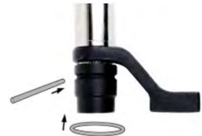
ILUSTRACIÓN 16 - Sujeción del dado
