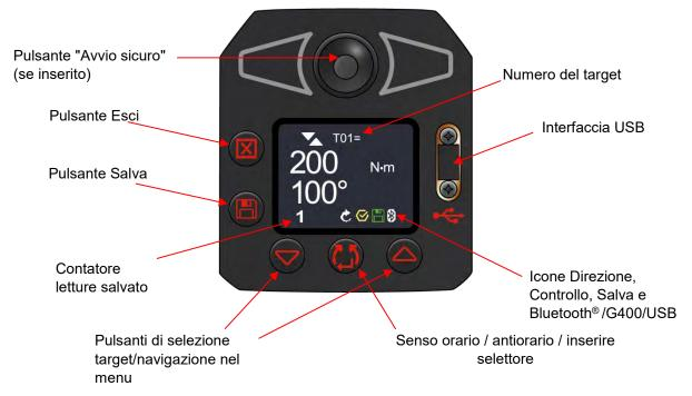
FIGURA 2 - Caratteristiche dell'interfaccia utente
